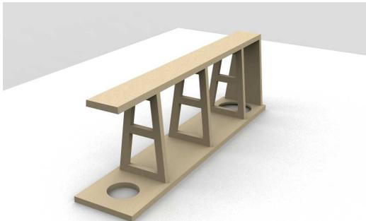
Die Rückwand kann auf die vorhandenen Versteifungen verklebt werden. Achten Sie bitte genau auf die Ausrichtung der Rückwand. Alle Versteifungen müssen mit den Schrägen an der Rückwand bündig abschließen. Somit können Sie sicher sein, dass die Seitenteile bündig abschließen und das Gehäuse dicht ist.
