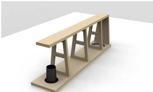
Das äußere Bassreflexrohr kann jetzt schon in der Front montiert werden. Somit können Sie das zweite Rohr auf der Innenseite vom Lautsprecher montieren. Die Rohre werden auf 125 mm gekürzt und Rücken an Rücken im Gehäuse verklebt. Bitte achten Sie darauf, dass Sie die Rohre erst im Gehäuse zusammen kleben.
