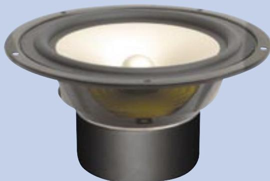
175 mm-Tief-Mitteltöner mit Alu-Membran, Stahlblechkorb und magnetischer Abschirmung. Linearer Frequenzverlauf bis 4500 Hz. Vorzugsweise für den Einsatz in geschlossenen oder Bassreflex 2-Wege-Systemen ab 6 Litern. Besonders empfehlenswert für design-orientierte Heimkino-Lösungen.
