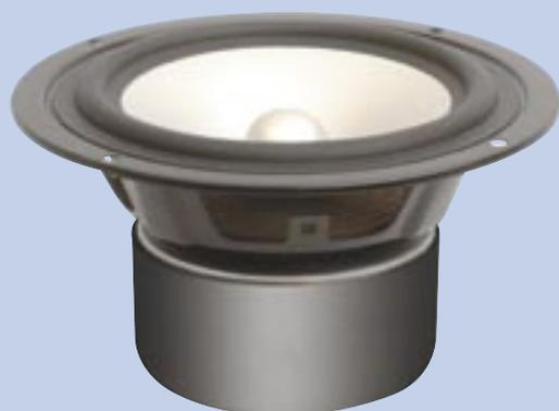
130 mm-Breitband Tief-Mitteltöner mit Alu-Membran, Stahlkorb und magnetischer Abschirmung. Linearer Frequenzverlauf bis ca. 6000 Hz. Vorzugsweise einsetzbar im Bassreflex-Gehäuse ab 8 Litern. Sehr gut geeignet für PC oder Heimkinoanwendungen.
